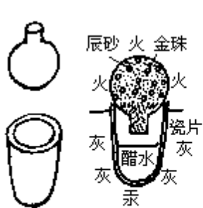
图5 石榴罐炼汞示意图
